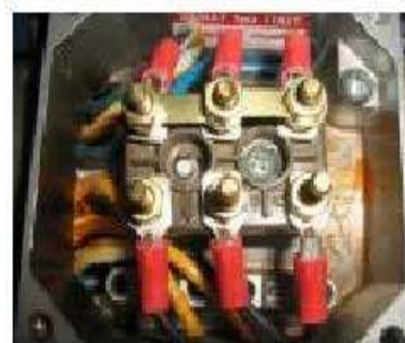
عکس اتصال ستاره روی ترمینالهای موتور
